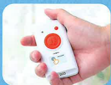
緊急呼出ボタン
